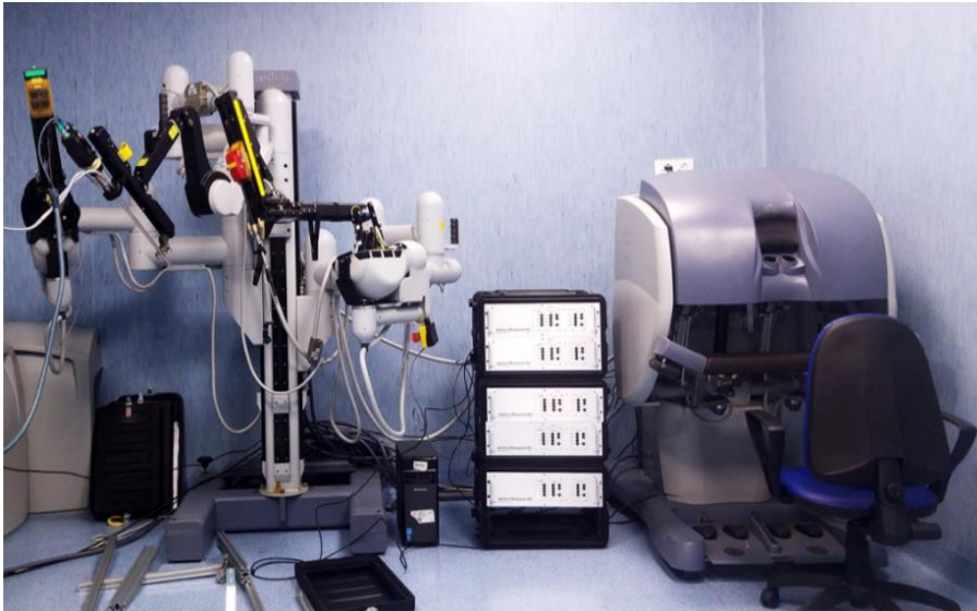
Figura 1 - dVRK presente nel laboratorio ICAROS
